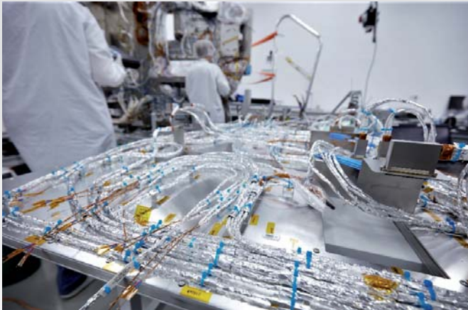
Verkabelung MTG Y + Panel, im Hintergrund MTG-Plattform-Mock-up.
