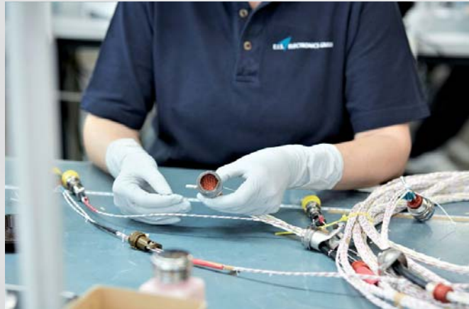
Endmontage am Kabelbaum für Ariane 5. Fotos: E.I.S. Electronics GmbH
