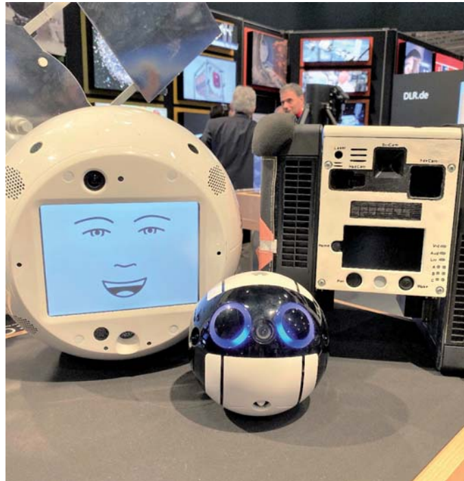
Deutschland hat technologisch die Nase vorn. Drei fliegende Roboter für den ISS-Einsatz: CIMON (DE), Int-Ball (Japan), AstroBee (USA) (v. l.n.r.).
